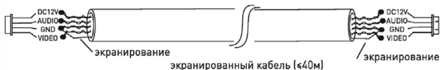
Экранированный сетевой кабель ( \leq 40\text{м} )
